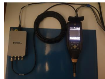
Figura 9: Montagem em série com o sonômetro B&K 2270
