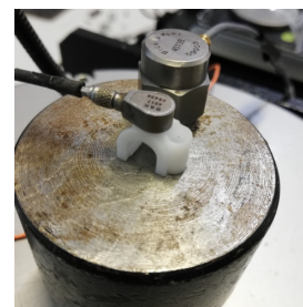
(a) Detalhe da base com o elemento elástico e acelerômetro no topo, como massa de carregamento.
