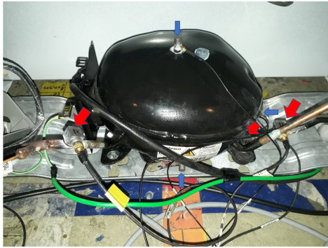
Figure 4: Compressor instrumentado: as setas vermelhas indicam os acelerômetros triaxiais e as setas azuis os uniaxiais. [1]
