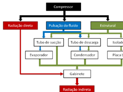
Figure 2: Contribuição de fontes de ruído de um refrigerador típico. [2]
