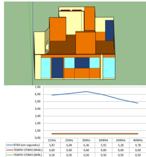
Figura 3: Simulação e gráfico de tempo de reverberação do estabelecimento 02A (Interno).
