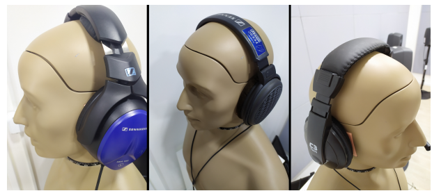
Figura 9: Fones de ouvido utilizados para a validação posicionados no manequim KEMAR.
