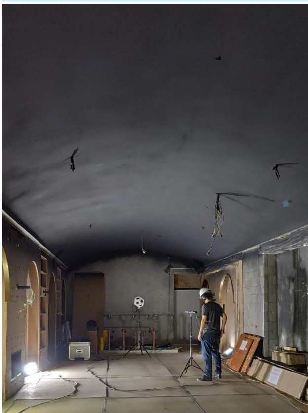
Figura 5: Jazz Bar com plaster acústico durante a segunda medição do ( T_{20} ).
