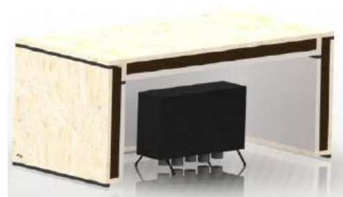
Figura 9: Corte da seção da caixa isoladora com tapping machine posicionada e sem amostra de teste.
