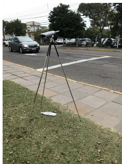
Figura 6: Exemplo de medição de nível de pressão sonora em um ponto de coleta.
